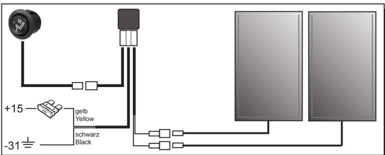
Elektrischer Anschluss an das Bordnetz:
