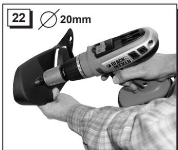
22. Mit einem 20mm Stufenbohrer ein Loch an einer freien Stelle bohren
